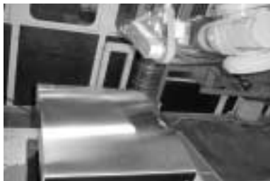
ROBOT SPAZZOLATURA 1 impianto robotizzato di spazzolatura, trattamento e finitura acciaio inox
