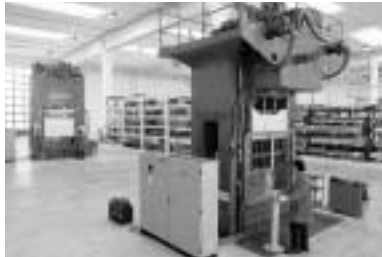
PRESSA IDRAULICA 1 MURARO 600 ton con piani da 1400x1200 dotata di premilamiera 400 ton
